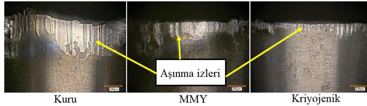
Şekil 4. Farklı işleme ortamlarında NiTi şekil hafızalı alaşımın 5 dk işlenmesinden sonra oluşan yan yüzey aşınma miktarlarının kıyaslanması [40].
